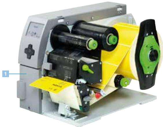
**1** Für Etikettendrucker zum Spenden (Typen „P“) werden zusätzlich ein Spendeadapter oder eine Spendelichtschranke benötigt. Es gibt Ausführungen sowohl für den Handbetrieb als auch für das Auslösen durch einen Handtaster, Fußschalter oder ein externes Steuersignal.
